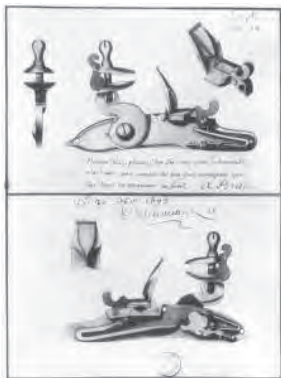
A017 Fig. 6.8. “Dessain d’une platine des Six cent qu’on a demandé, a la cour pour monter les 600 gros mousquets qui Sont dans let magazine en fusil. A Brest.” Dated 20 October, 1693 and signed Descloureaux. The design for a lock to convert the 600 large matchlock muskets in the magazine into flintlocks. [See M017], M Descloureaux. Paris, Archives Nationales, Marine , G5, Vol. 203
